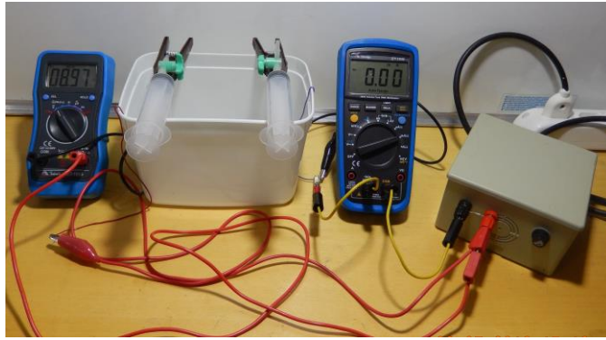
Figura 2: Foto do conjunto utilizado para produzir hidrogênio e medir as grandezas elétricas envolvidas. No experimento realizado em sala de aula, os medidores elétricos não são necessários.
